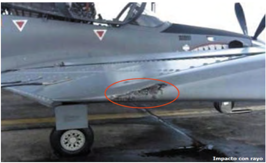
Figura 83. FAC 3106 impactado por rayo el 20/ABR/12. Fuente: Tomado de IGEFA (2012).
