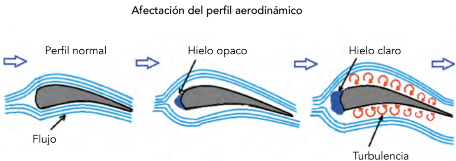
Figura 52. Interacción entre el tipo de hielo y el flujo de aire. Adaptado de FAA (2015).
