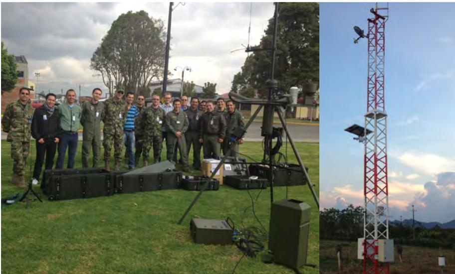
Figura 2. Estación portátil (TACMET) a la izquierda y fija (EMA) a la derecha.
