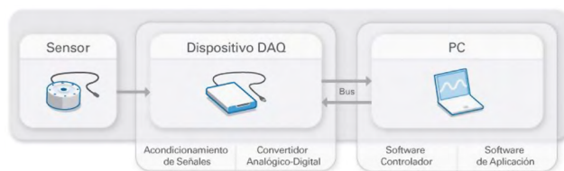
Figura 8. Esquema del sistema propuesto para adquisición y transmisión de datos
